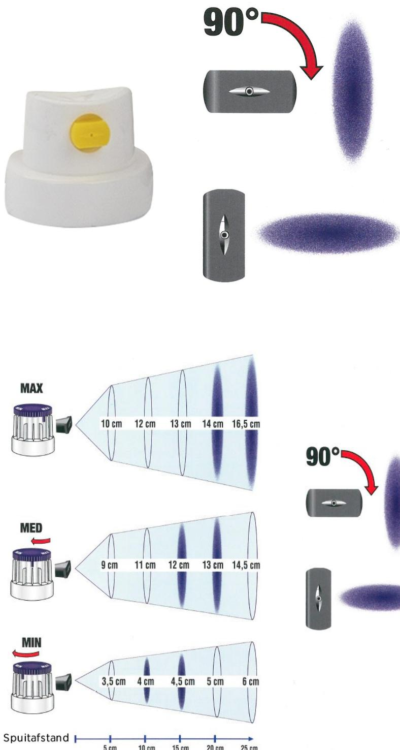
De multifunctionele sputtkop met rode draaischijf aan de bovenzijde en het sputtgedeelte aan de voorzijde (nozzle) kan op diverse manieren gebruikt worden om een goed sputtbeeld te krijgen. Door de nozzle in de kop te draaien (voorzichtig met een tang), kunt u de stroom van lak horizontaal of verticaal instellen.
